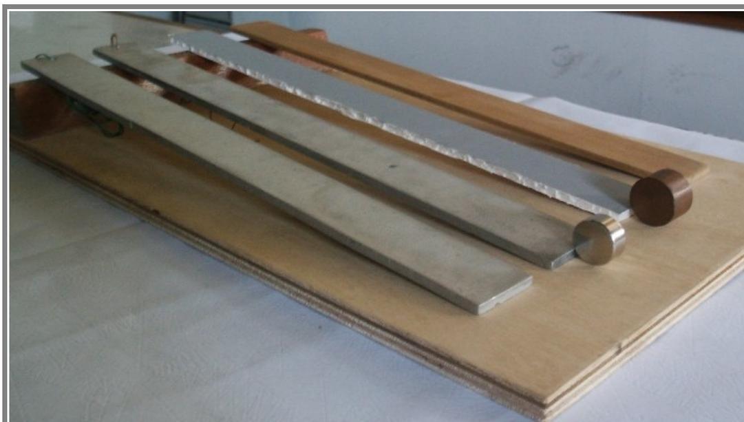
**F:** En este experimento se hacen rodar dos cilindros, uno magnético (el más chico), el otro no magnético (el más grande), por rampas diferentes. Las dos primeras rampas son de aluminio (a diferentes temperaturas). La tercera es de plástico y la cuarta de madera.
