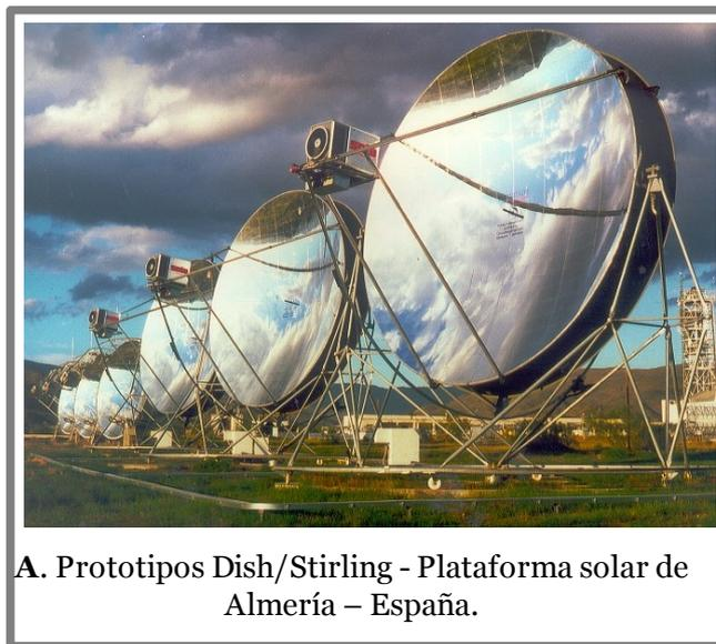
A. Prototipos Dish/Stirling - Plataforma solar de Almería – España.
